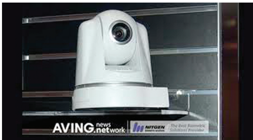
La telecamera Sony SNC-RZ50N è dotata di remotaggio del movimento e dell'ottica nonché della capacità di veicolare il video over-IP.
